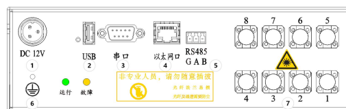
图一 23 型号接口示意图
